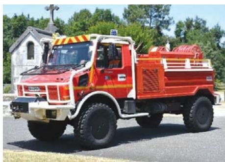
Les **CCF** : **C**amion-**C**iterne **F**eu de **F**orêt au nombre de deux, chacun transporte une quantité d'eau de 3000 litres. Ce qui nous donne une autonomie de 15 à 30 minutes suivant la lance utilisée. Devant des feux de plus en plus virulents, ils sont également équipés de protections en eau de la cabine et du châssis ainsi que d'une bouteille d'air. Ces deux systèmes nous permettent de rester à l'abris des flammes dans la cabine le temps que le feu passe.
