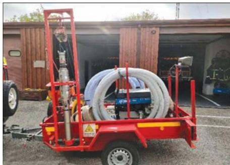
La **MPI** : La **M**oto **P**ompe **I**mmergée tractée par la VLHR lors des feux de forêt, permet de ravitailler en eau au plus près du sinistre les CCF. Ces forages, au nombre de 20 sur la commune sont créés et entretenus par la **D**éfense **F**orêt **C**ontre l'**I**ncendie (**DFCI**).
